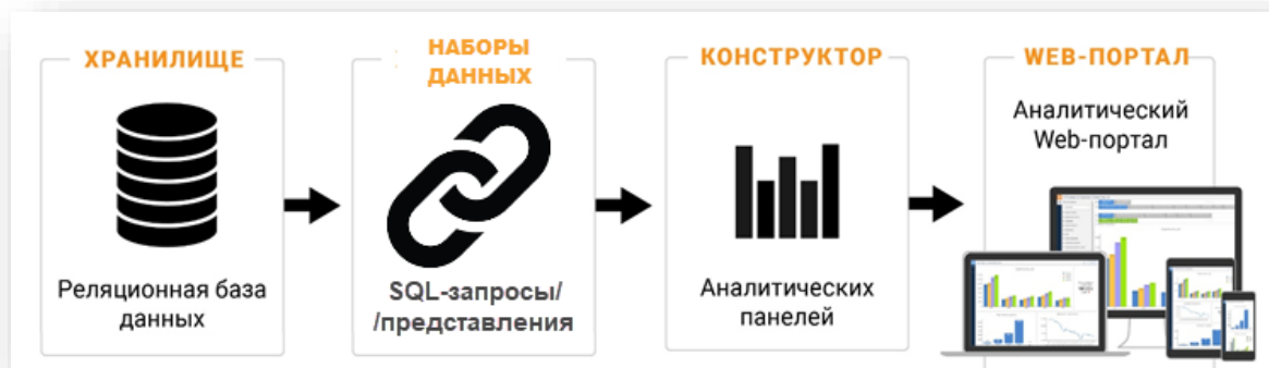
Рисунок 2. Схема взаимодействия аналитического портала с внешними источниками данных и компонентов портала между собой
